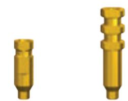
Трансферы D2 выпускаются с винтами D2a или D2a1. Короткий винт – для закрытой оттисковой ложки, а длинный винт – для открытой оттисковой ложки.
